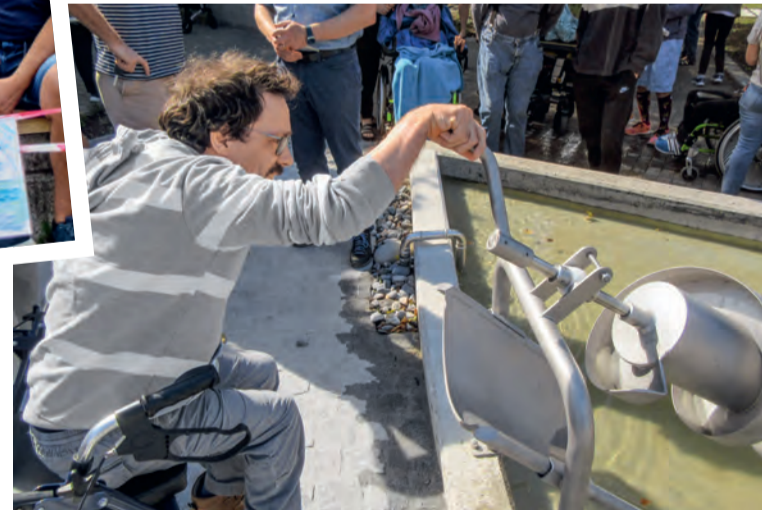
Die archimedische Schraube wird gedreht, um das Wasser aus dem Becken und wieder zurück ins Becken zu befördern.
