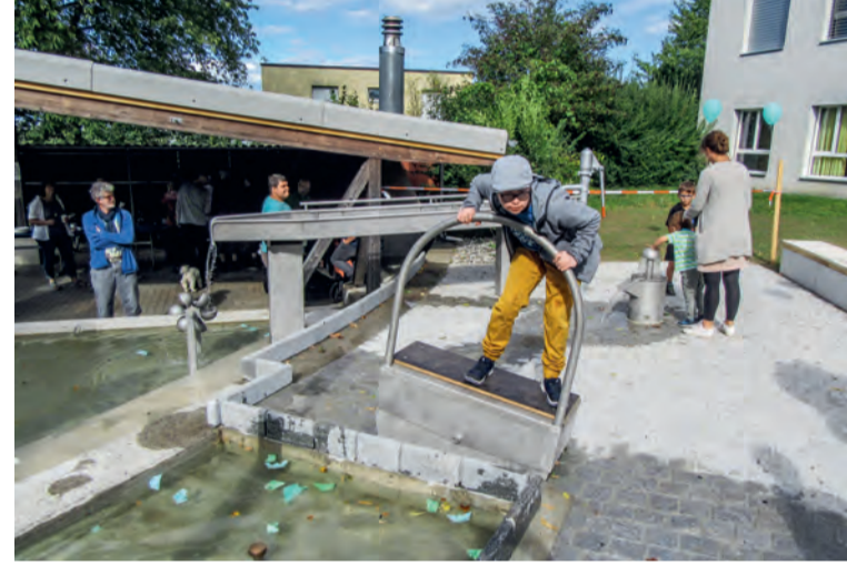
Mit der eigenen Körperkraft wird das Wasser mit der Wippsaugpumpe zu einer Wasserfontäne befördert.
